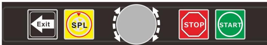
Тип Б: выбор функций производится с помощью центральных кнопок.
