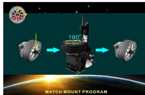
Накачайте шину и установите колесо так, чтобы контрольные отметки совпадали между ободом и адаптером.
