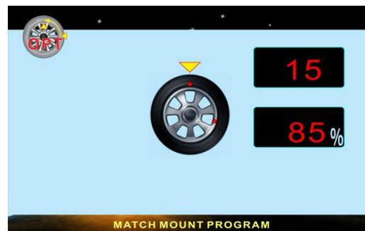
Вращайте колесо до тех пор, пока точка индикации положения шины не окажется вверху, отметьте линию на шине в верхнем центре положения 12 часов.
