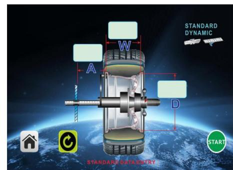
Прежде чем колесо можно будет сбалансировать, необходимо ввести данные об измерениях колес. Есть 2 способа ввода колесных данных A, D и W, ручной ввод и автоматический ввод.
