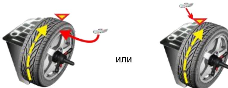
Установите балансировочные грузы с отображаемым количеством на внутреннюю или внешнюю плоскость на ободе в положении 12 часов.
