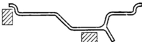
**ALU2** - комбинированная балансировка: набивной груз внутри; скрытое нанесение клеевого груза снаружи. (Положение внешнего веса, как в ALU 1).
