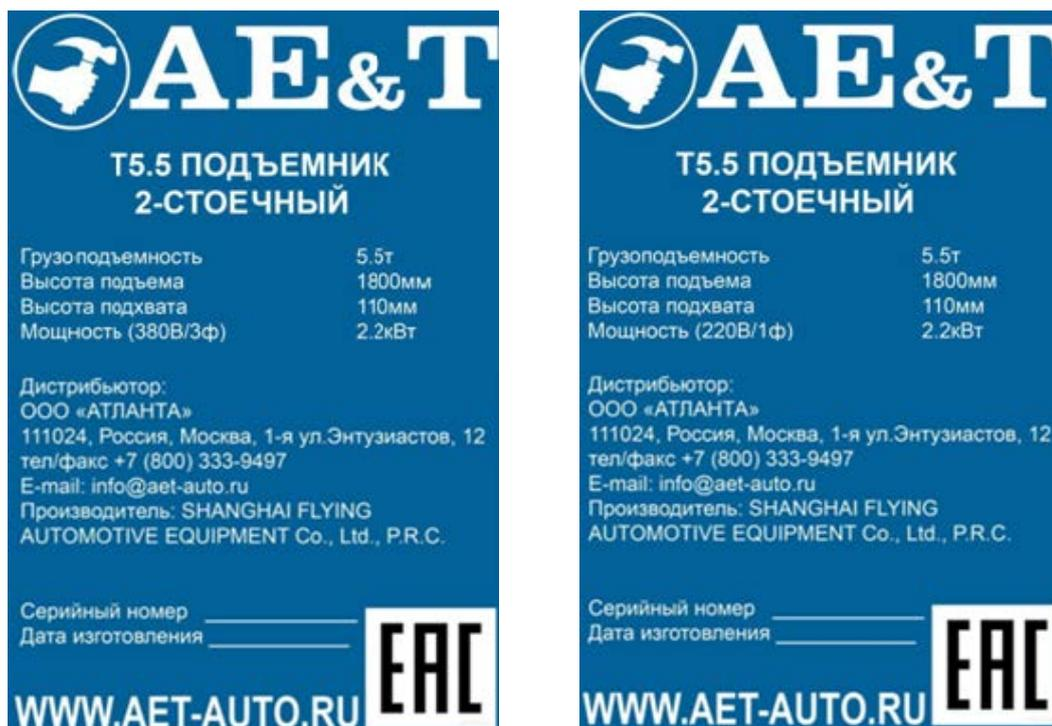
Рис. 10. Табличка с паспортными данными.
