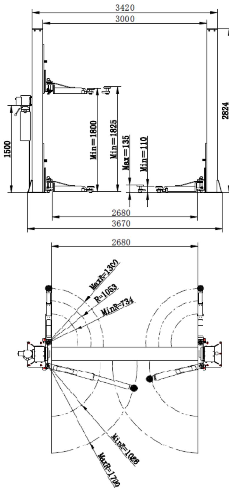
Рис. 1. Габаритные и функциональные размеры.
