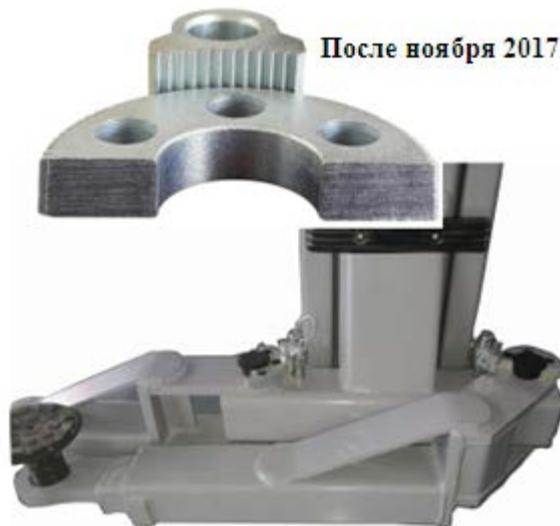
Рис. 2. Блокировка балок подхвата
