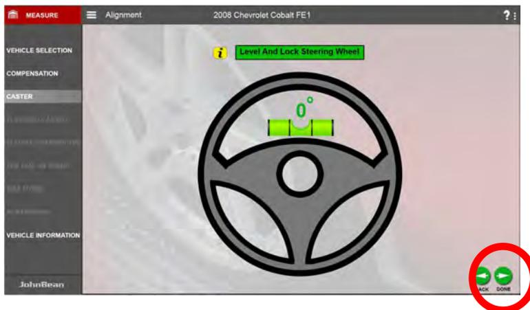
Нажмите «Done», чтобы перейти к измерению угла продольного наклона оси поворота.
